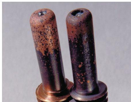
Электрод после нормальной эксплуатации, электрод после избыточного использования
